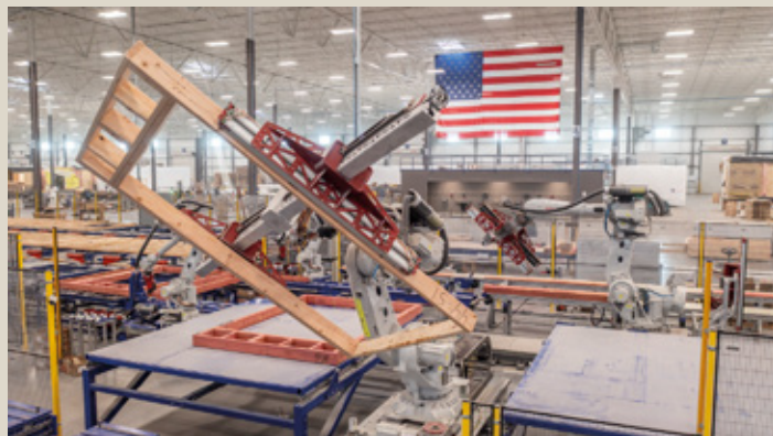
Assemblage robotisé de cadre bois - Courtesy from Autovol Idaho
