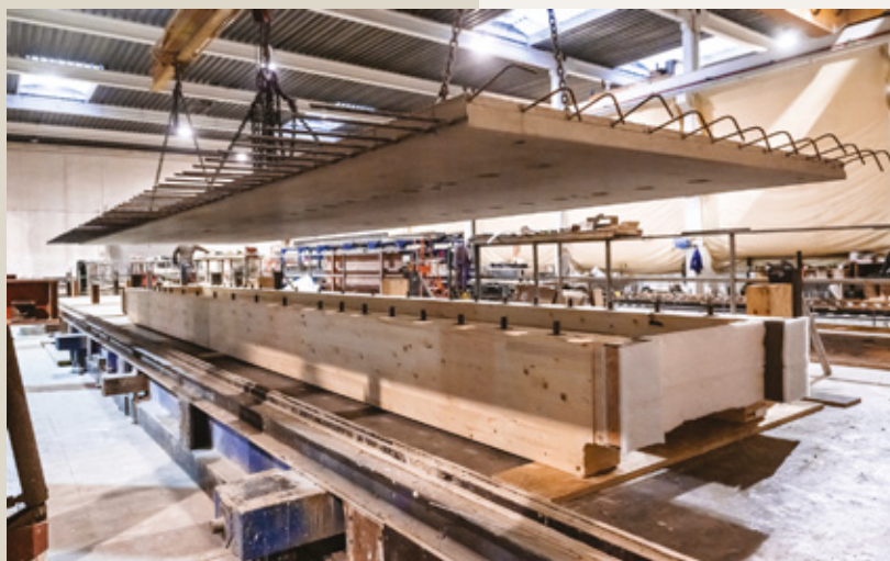
Un panneau Atom Wood, un nouveau plancher mixte bois-béton, en cours d’assemblage en usine. Photo : Laurent Barranco
