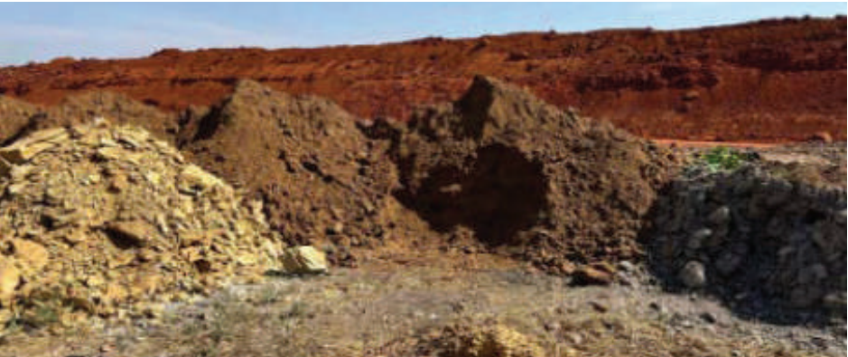
Figure 6. Différentes terres utilisées dans la confection de briques en terre crue © Présentation de Nzinga Mboup (WOROFILA) à la conférence internationale MS*IBD du 9 avril 2025.
